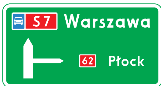
Rys. 6.3.1.7. Tablica E-1 na początku drogi ekspresowej
