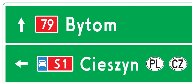
Rys. 6.3.2.4. Drogowskaz E-2a wskazujący dojazd do drogi ekspresowej
