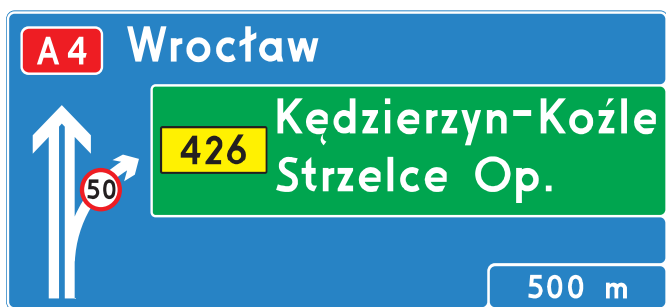
Rys. 6.3.1.9. Tablica E-1a – II na autostradzie przed skrzyżowaniem z drogą wojewódzką
