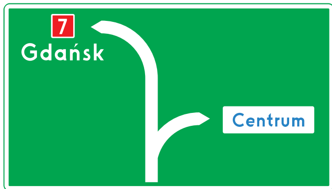
Rys. 6.3.1.6. Tablica E-1 podająca informację lokalną
