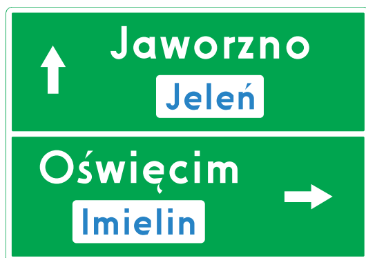
Rys. 6.3.2.7. Drogowskaz E-2a zawierający informację lokalną
