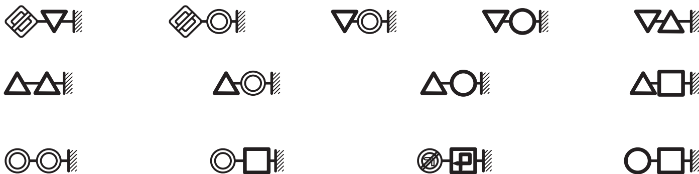
Rys. 1.5.2. Sposoby umieszczania dwóch znaków w układzie poziomym
