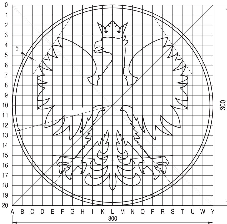
Rys. 9.6.3. Szablon orła do znaków F-1 i F-2
