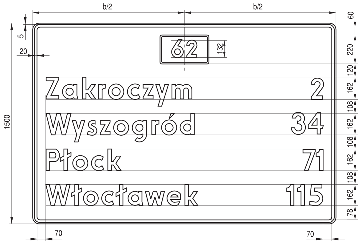
Rys. 9.5.44. Konstrukcja znaku E-14
