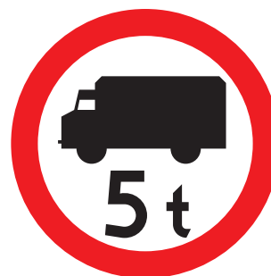
Rys. 3.2.6.2. Znak B-5 podający masę pojazdu
