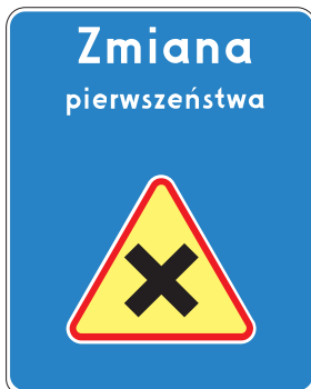
Rys. 5.2.54.1. Znak D-48 wskazujący skrzyżowanie dróg równorzędnych
