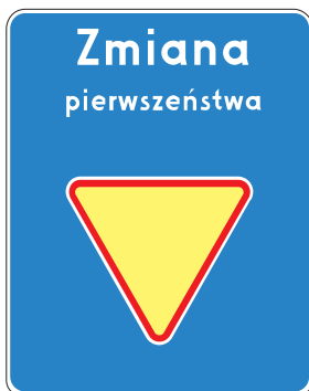
Rys. 5.2.54.2. Znak D-48 wskazujący wlot podporządkowany
