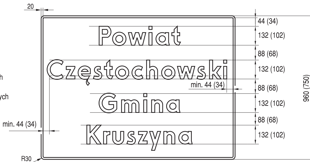
Rys. 9.6.5. Konstrukcja znaku F-3b
