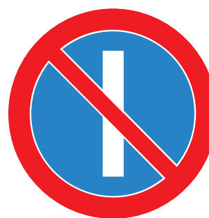
Rys. 3.2.38.1. Sposób wskazywania zmian zakazów wynikających ze znaków B-35 i B-36
