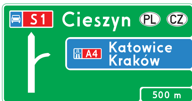
Rys. 6.3.1.11 Tablica E-1b przed węzłem, na którym rozpoczyna się droga ekspresowa i następuje wjazd na autostradę
