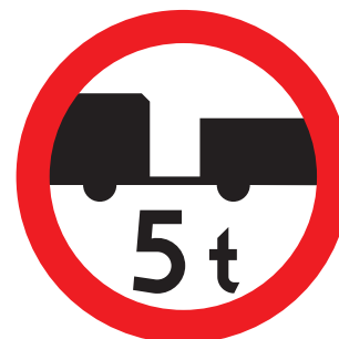
Rys. 3.2.8.2. Znak B-7 podający masę przyczepy
