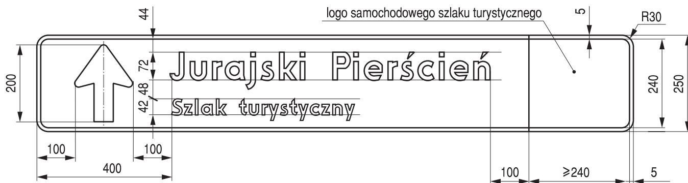
Rys. 9.5.54. Konstrukcja znaku E-22a
