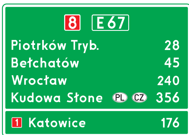
Rys. 6.3.6.2. Tablica E-14 z nazwami dwóch miejscowości kierunkowych
