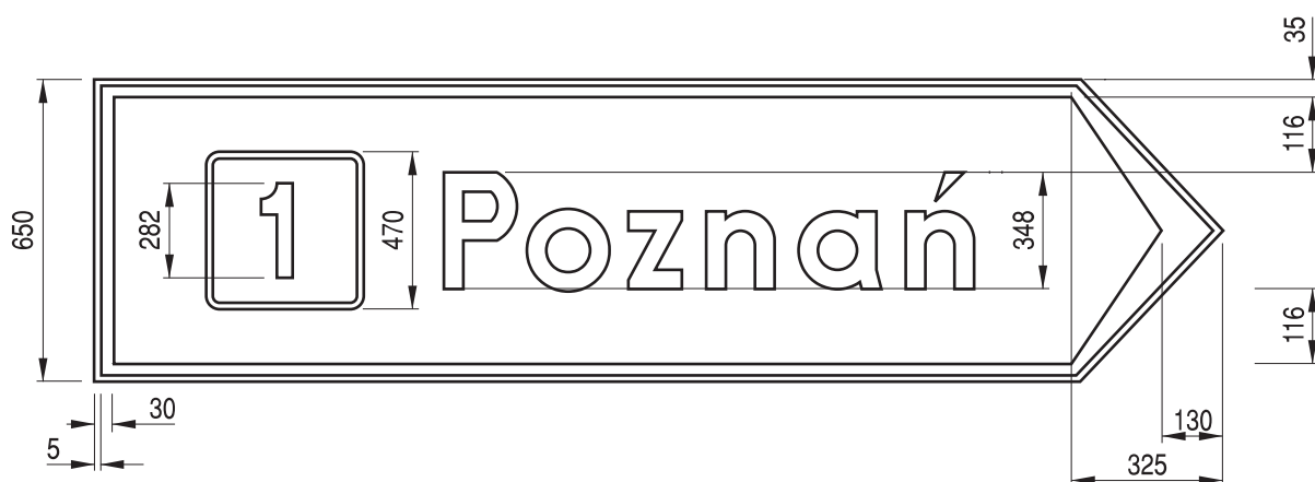
Rys. 9.5.24. Konstrukcja znaku E-3
