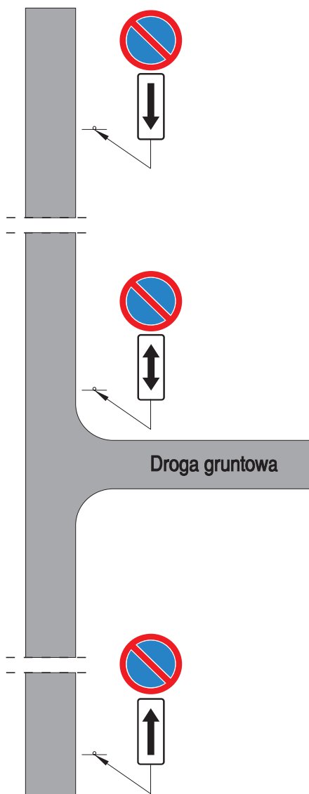
Rys. 3.2.36.6. Zastosowanie tabliczek T-25a, T-25b, T-25c
