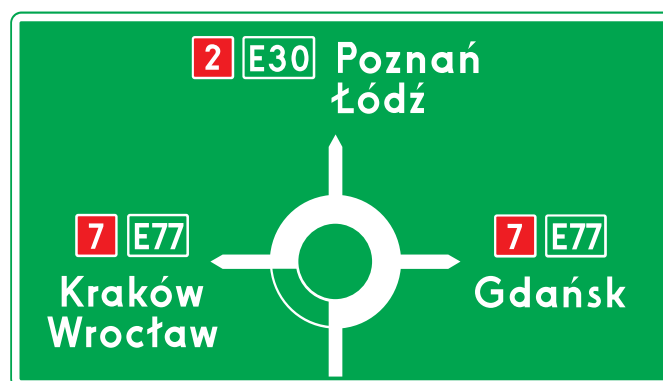
Rys. 6.3.1.4. Tablica E-1 przed skrzyżowaniem o ruchu okrężnym
