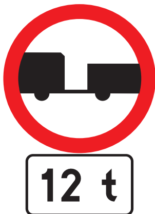
Rys. 3.2.8.3. Znak B-7 z tabliczką podającą masę przyczepy
