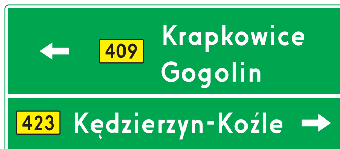
Rys. 6.3.2.2. Drogowskaz E-2a z nazwami dwóch miejscowości kierunkowych na jednym kierunku
