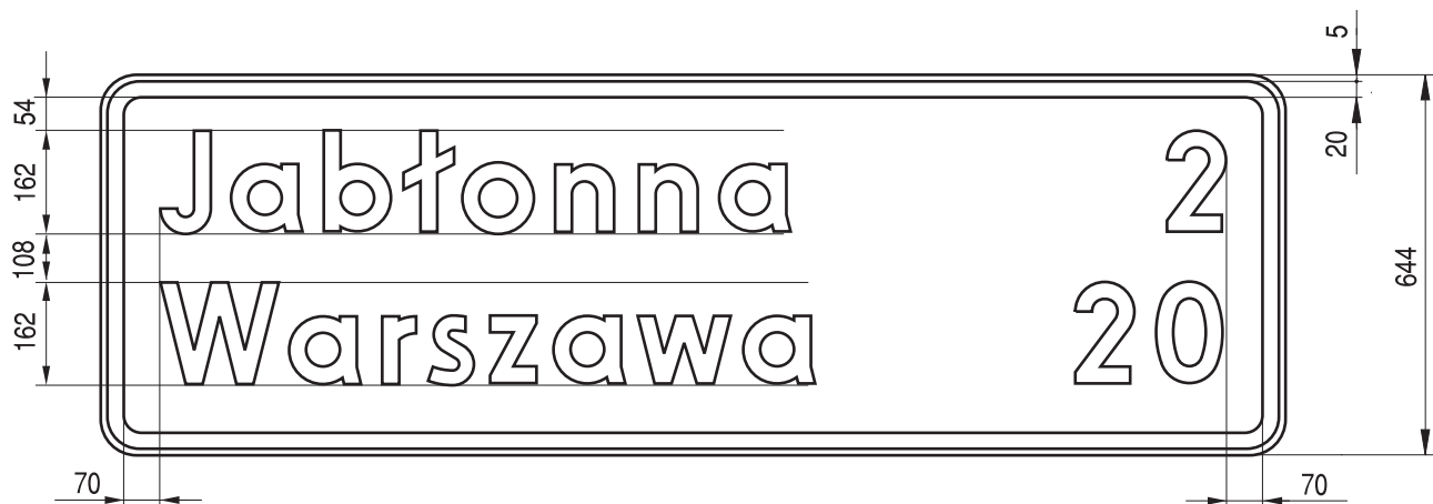
Rys. 9.5.43. Konstrukcja znaku E-13
