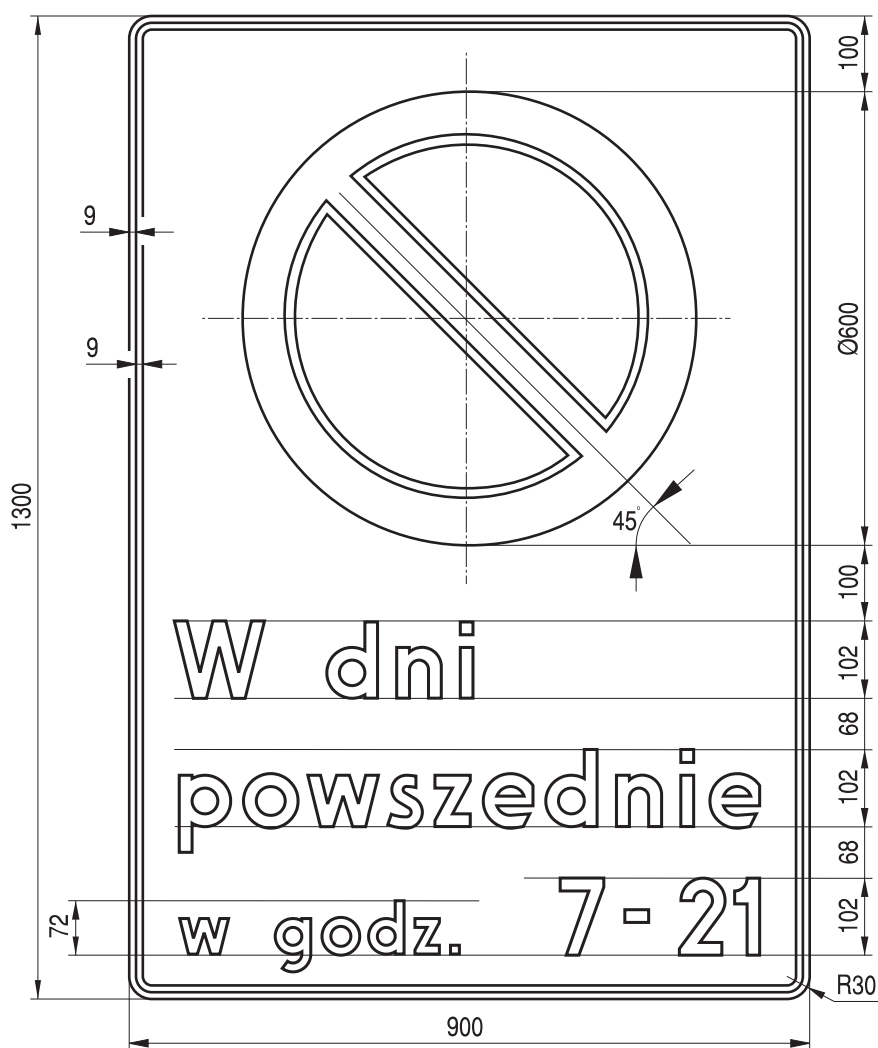
Rys. 9.2.47. Konstrukcja znaku B-39
