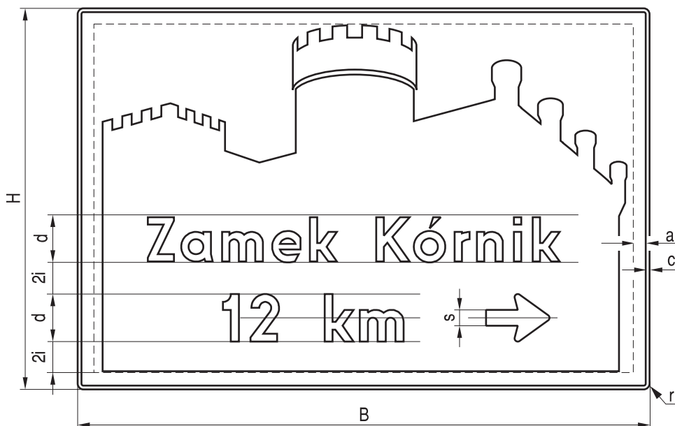
Rys. 9.5.56. Konstrukcja znaku E-22b
