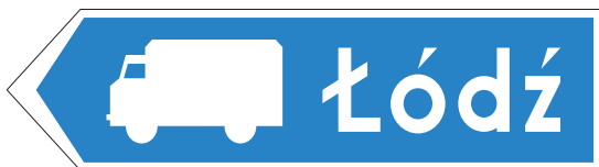
Rys. 7.2.13.2. Znak F-13 wskazujący przejazd tranzytowy do miejscowości
