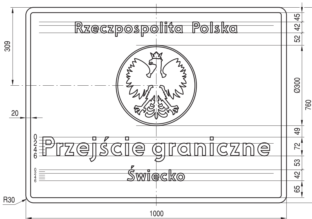
Rys. 9.6.1. Konstrukcja znaku F-1
