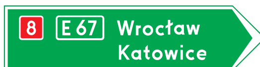
Rys. 6.3.2.10. Drogowskaz E-3 z dwiema nazwami miejscowości kierunkowych
