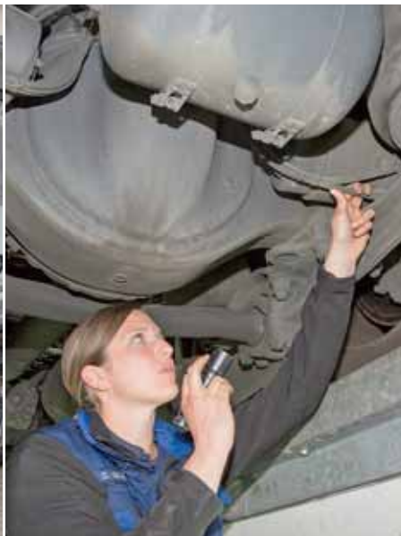
Die HU beginnt mit einer äußeren Sichtkontrolle – ehe es, nach der Probefahrt, tief in die Details der Mechanik und Pneumatik geht
