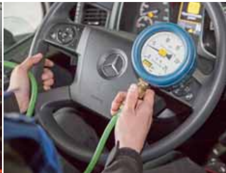
Neben elektronischen Messverfahren kommen nach wie vor manuelle Druckmessverfahren im Bereich der Bremse zum Einsatz
