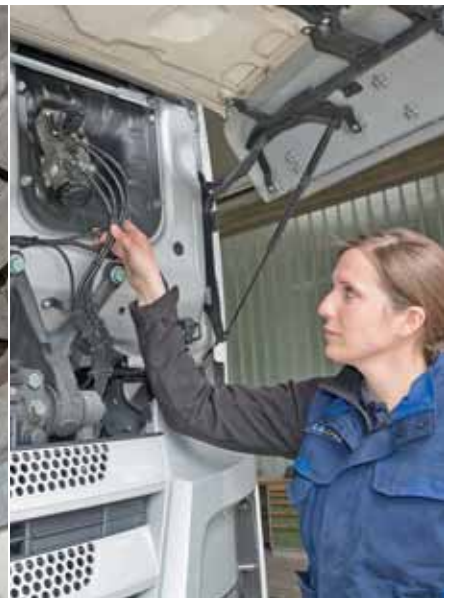
Die HU beginnt mit einer äußeren Sichtkontrolle – ehe es, nach der Probefahrt, tief in die Details der Mechanik und Pneumatik geht
