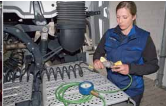
Neben elektronischen Messverfahren kommen nach wie vor manuelle Druckmessverfahren im Bereich der Bremse zum Einsatz
