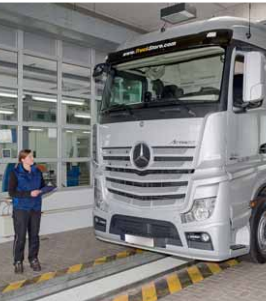
Die HU beginnt mit einer äußeren Sichtkontrolle – ehe es, nach der Probefahrt, tief in die Details der Mechanik und Pneumatik geht
